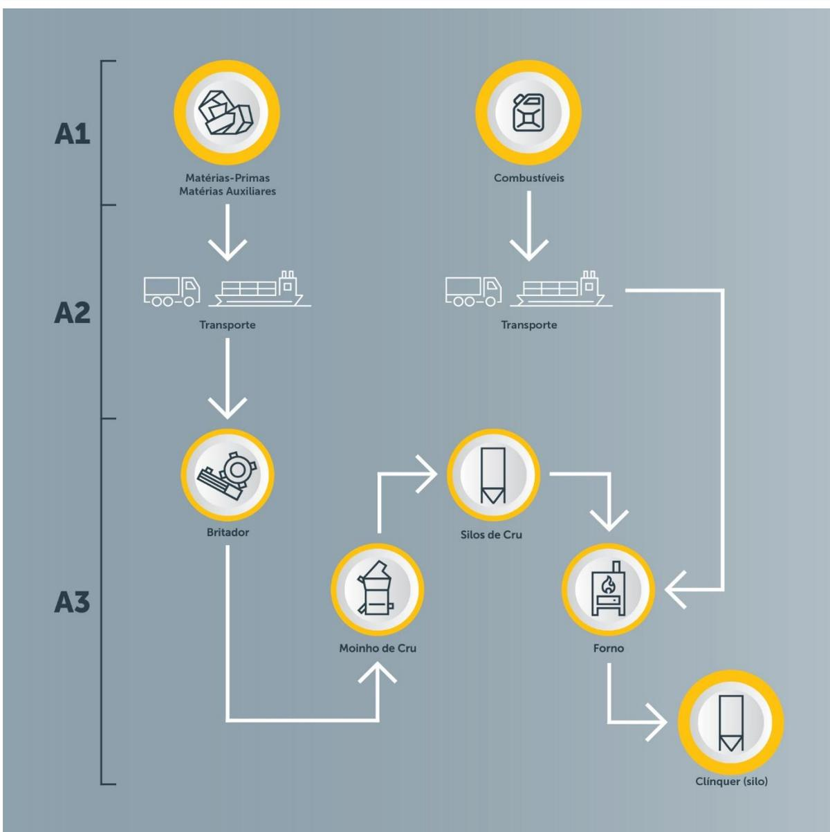
Figura 1: Fluxograma do processo de fabricação do Clínquer Portland.
