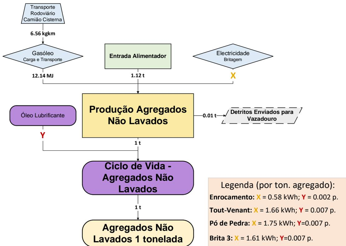
Figura 1: Fluxograma simplificado para o inventário da produção de Agregados Não Lavados.
