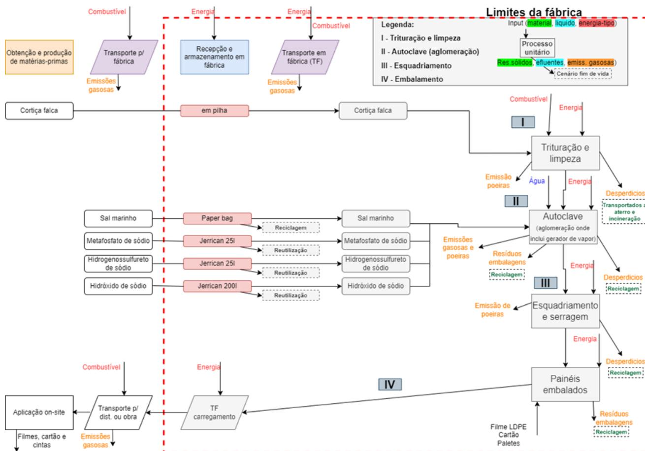
Figura 1: Sistema de produção considerando os processos de produção dos painéis de ICB analisados (fluxograma do processo estudado na ACV; na unidade de Telhado) do ciclo de vida e processos unitários do produto.
