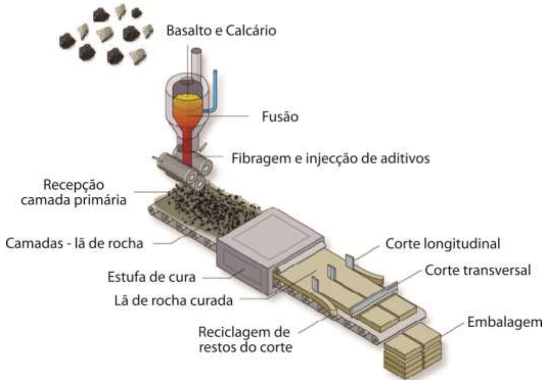
Figura 2. Fase de produção de painéis ou mantas de lã de rocha (fonte: TERMOLAN).
